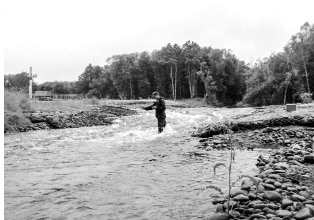
Рис. 20. Измерение скорости потока в русле одной из двух второстепенных пойменных проток р. Авачи через 4 мес. после завершения строительства ППМГ (реконструкции перехода МГ в траншею): в центре снимка – значительный искусственный перепад в створе габрионов над валиками обратной засыпки, на заднем плане слева – блок-контейнер энергоснабжения кранового узла (фото 13.08.2012 г.)
